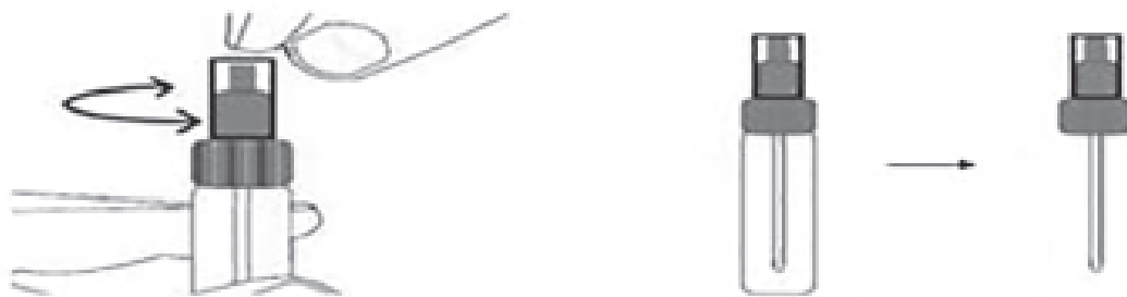
نحوه باز کردن لوله جمع‌آوری نمونه
